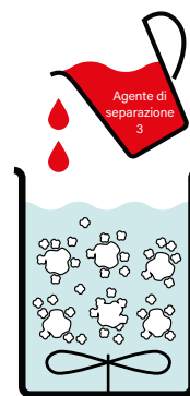
FASE 3: Avviare la flocculazione aggiungendo l'agente separatore 3 per separare l'olio dall'acqua. Il processo dura almeno 30 minuti. Idealmente, l'agente può maturare per 24 ore.
